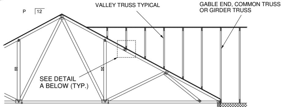
SECURE VALLEY TRUSS W/ ONE ROW OF 10d NAILS 6" O.C.
