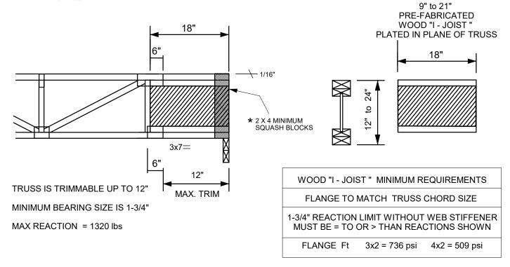
\* SQUASH BLOCKS REQUIRED WHEN WALL LOADS FROM ABOVE ARE PRESENT. SQUASH BLOCKS ARE TO BE 1/16" TALLER THAN TRUSS. ATTACH SQUASH BLOCKS TO EACH FACE OF TRUSS WITH THREE 10d (0.131" X 3") NAILS IN EACH END. MAXIMUM WALL LOAD IS 7612 LBS.
