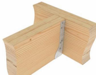
TYPICAL HD-IF INVERTED FLANGE INSTALLATION
