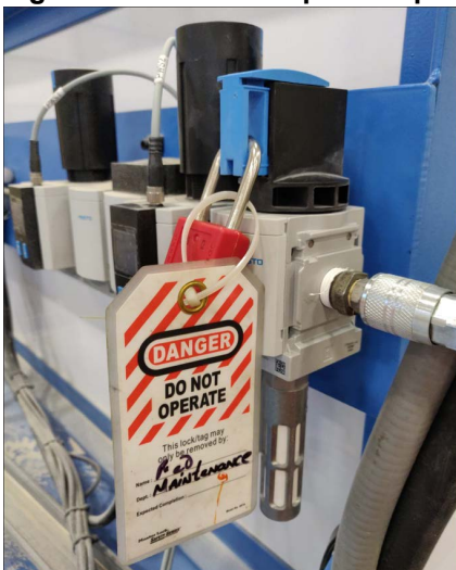
Figura 2-5: Cómo bloquear/etiquetar el sistema neumático
