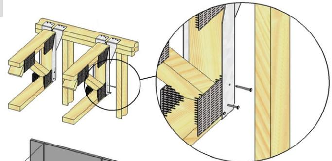
**5.** Marque la ubicación de los colgadores FWH y corte un agujero de 20,32 cm utilizando el modelo de muro ignífugo, la herramienta de corte del panel de yeso y la broca de corte en espiral.
