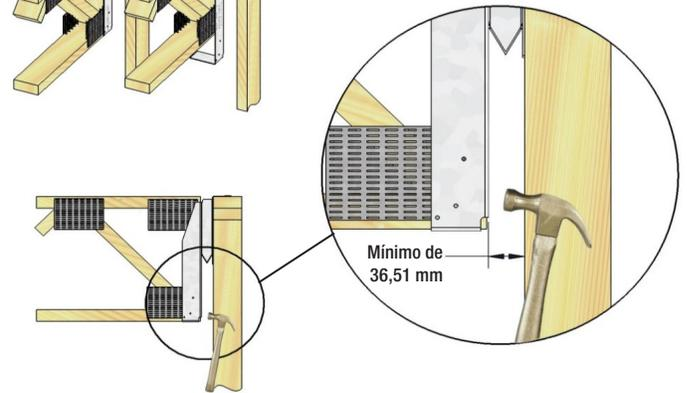
4. Clave el colgador FWH a la cercha utilizando los sujetadores especificados.
