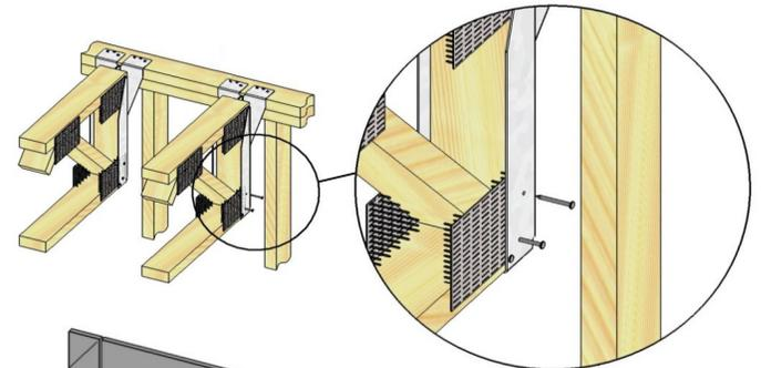
5. Marque la ubicación de los colgadores FWH y corte un agujero de 20,32 cm utilizando el modelo de muro ignífugo, la herramienta de corte del panel de yeso y la broca de corte en espiral.
