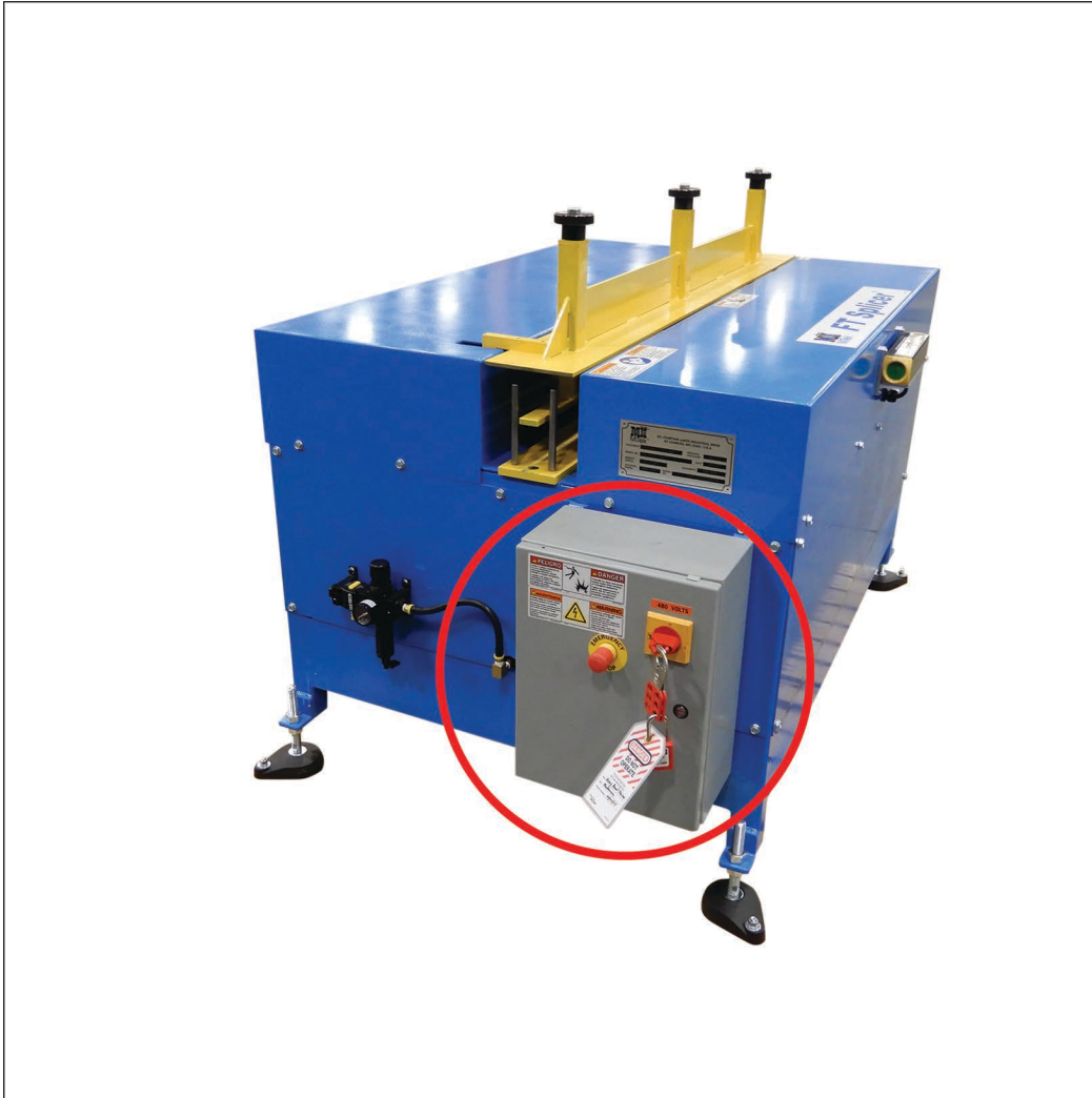
Figura SEGURIDAD-1: Bloqueo y etiquetado en el gabinete eléctrico principal
