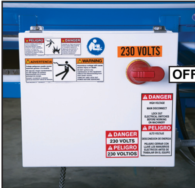
Figure SEGURIDAD-2: Bloqueo/etiquetado en equipo otras en el sistema
